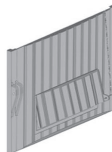
Рис.3. Регулировочная дверца подачи первичного воздуха
